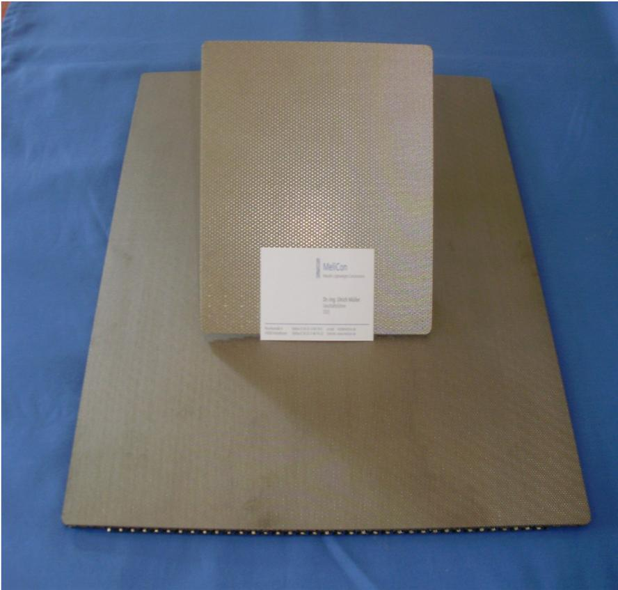
MELIDIFF® ist ein speziell für den Einsatz in PEM Elektrolyseanlagen entwickeltes metallisches Streckmetallaminat. Die rein metallischen MELIDIFF® Gasdiffusionslagen bilden zusammen mit der protonenleitenden Membran (PEM) das Kernstück der PEM Wasserelektrolyse. Die MELIDIFF® leitet den Strom und das Wasser an die Membran und führt die sich bildenden Gase H<sub>2</sub> und O<sub>2</sub> gleichzeitig ab.
